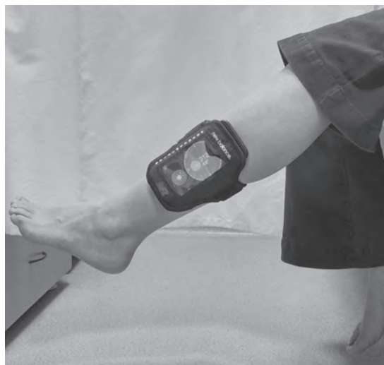
Figure 1.—JPS measurement with iPhone application. Figura 1. — Valutazione del JPS con un'applicazione per iPhone.
