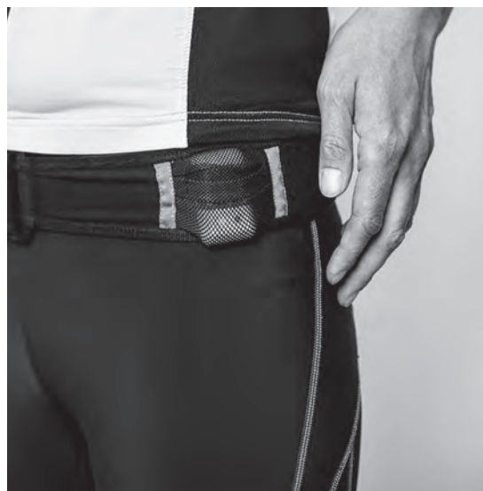
Figure 2.—Jump sensor. Figura 2. — Sensore di salto.
